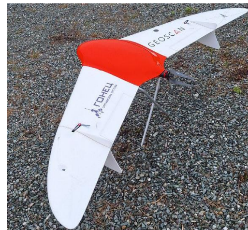
БВС «Геоскан 201» с оборудованием «Гонец»
